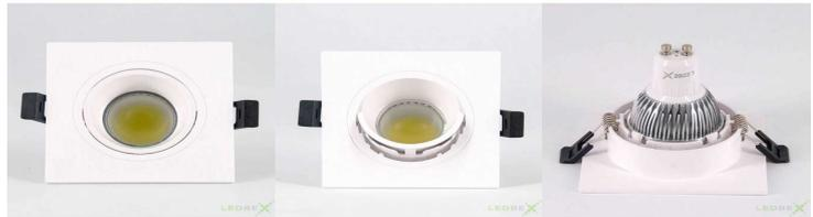
Soporte decorativo para empotrar una bombilla GU10. El diseño del soporte permite empotrar en cualquier superficie, ya sea un techo o pared. Además de que el interior del soporte es inclinable hasta un ángulo de 45 grados para orientar la luz donde se desee. Este soporte tiene un acabado rugoso en su superficie y un diámetro de corte para empotrado de 68mm. La bombilla GU10 no está incluida en el soporte y requiere adquirirla por separado.
