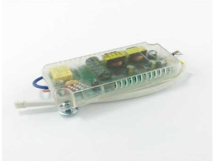
Circuito driver LED control CCT tres tonos de luz con **función TENUE**, compatible con el **MANDO 2.4 Ghz** función de ajuste suave, subir y bajar la intensidad.
